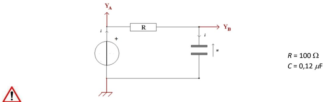
Astuce : pour **mesurer à la fois** la tension  $E$  aux bornes du GBF et du condensateur  $u$  pour placer correctement les bornes de l'oscilloscope.
