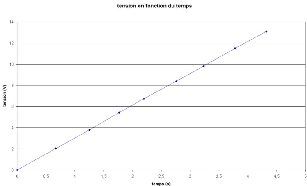
On constate que la tension aux bornes du condensateur est une fonction linéaire du temps.
