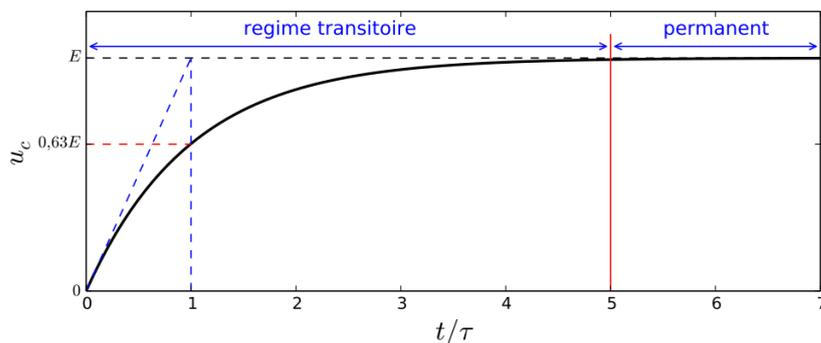
Au bout d'une durée de  $5\tau$ , on considère que la charge est complète (99%). Le régime est dit permanent, c'est-à-dire que la tension est constante et que l'intensité circulant dans le circuit est nulle.
